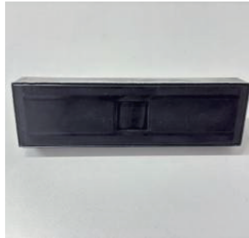
磁吸吸力面保持清洁, 无异物、碎渣 磁吸包胶完好无损
